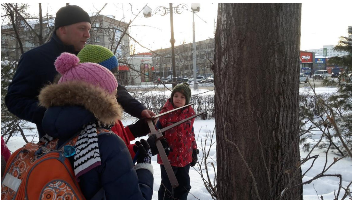
Фото 4. Измерение диаметра ствола с помощью мерной вилки.
