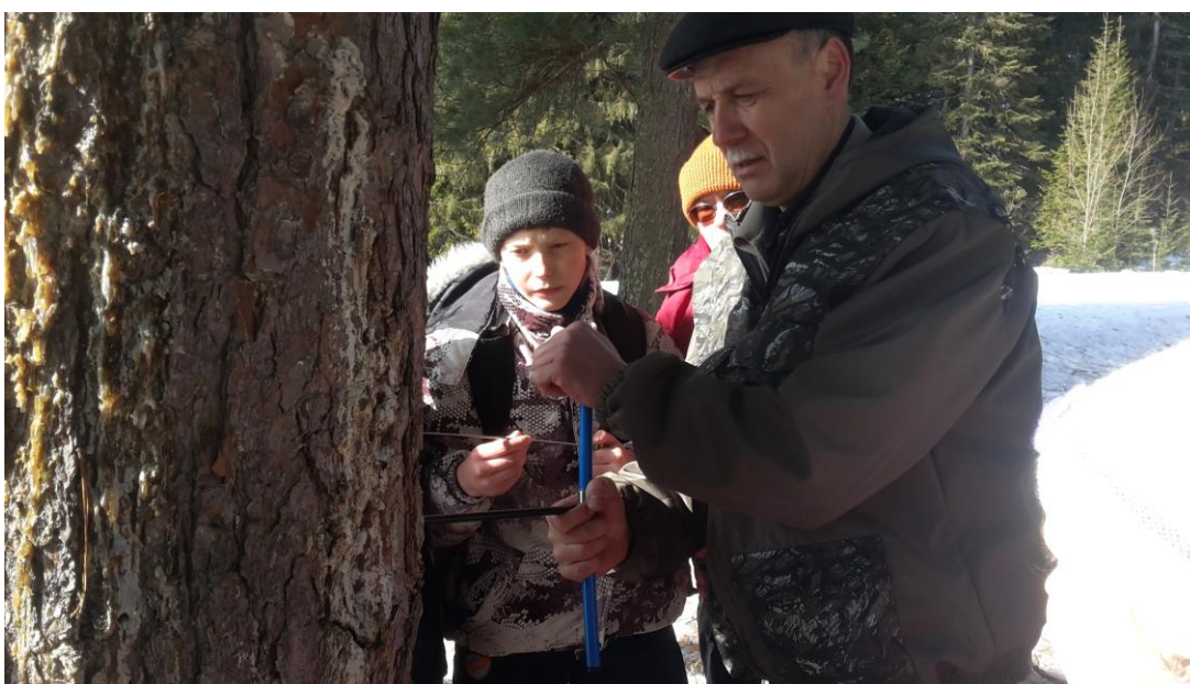
Фото 5. Определение возраста дерева с помощью возрастного бура Пресслера.
