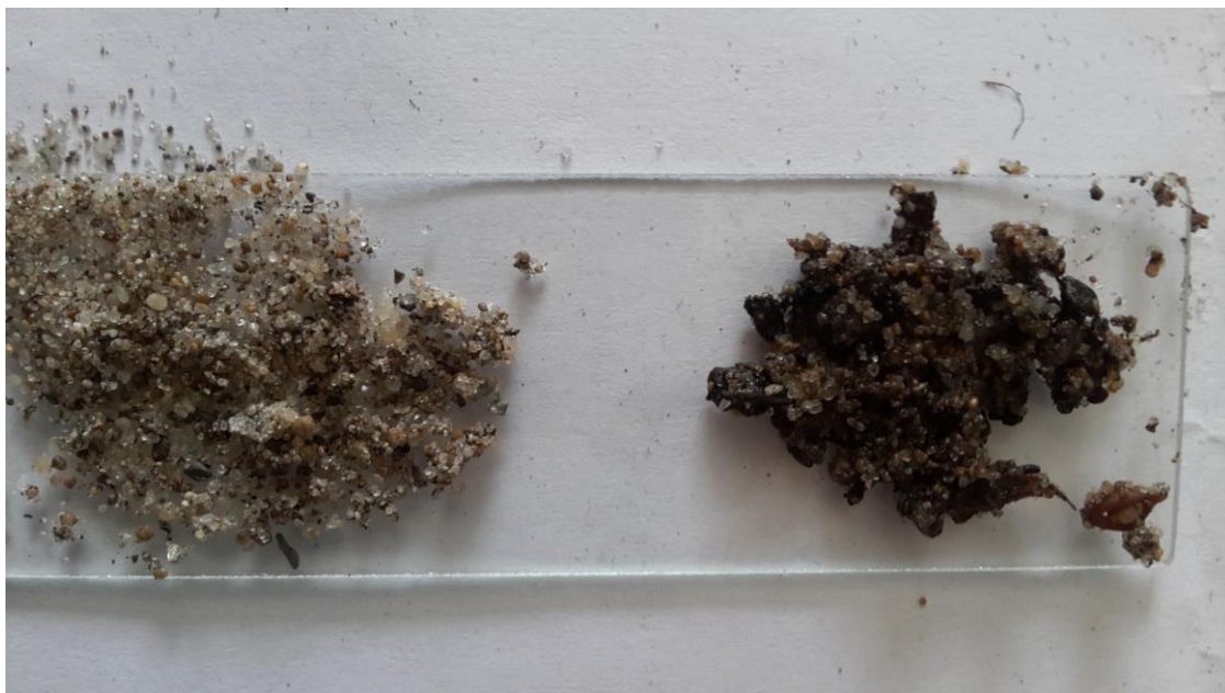
Фото 2. Слева – образец чистого песка, справа – этот же песок с включениями продуктов жизнедеятельности червей.
